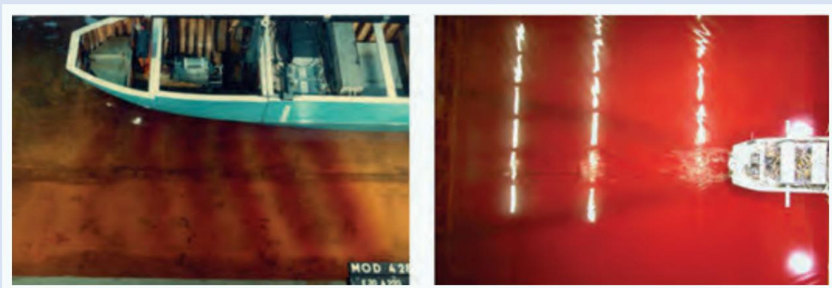
Figura 3 Patrón de propagación de ondas internas en la interfaz "agua-fluido denso", para viscosidades de 0,0002 Pa s en la imagen de la izquierda y 0,03 Pa s en la imagen de la derecha. (Delefortrie, G. & Vantorre, M. , 2015). Pa s es la abreviatura de la unidad de medida de la viscosidad, Pascales segundo.
